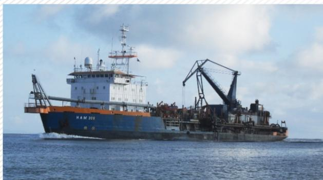
Draga HAM 309 (Draga de Sucção) - capacidade de cisterna de 4.890m<sup>3</sup> com comprimento total de 124,10m e 19,63m de largura.
