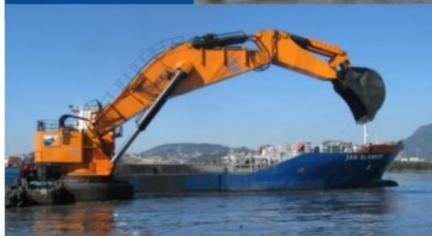
Como a draga mecânica não conta com local para acomodação do material, faz-se necessário durante a operação, a utilização de embarcações para transporte do material dragado. As embarcações utilizadas serão a JAN LEEGHWATER e a JAN BLANKEN, também da empresa Van Oord. As embarcações possuem uma capacidade de transporte de aproximadamente 2.800 m<sup>3</sup>.
